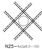
REFORÇO DOS FUROS DAS PAR.1 E PAR.4 (DN150) (3x) ESC.: 1:25
